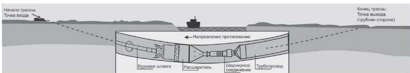
Протягивание трубопровода через буровой канал на буровую установку
