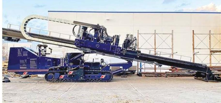
Буровая установка UNI 500x700 с прямым гидравлическим приводом на движение и вращение
