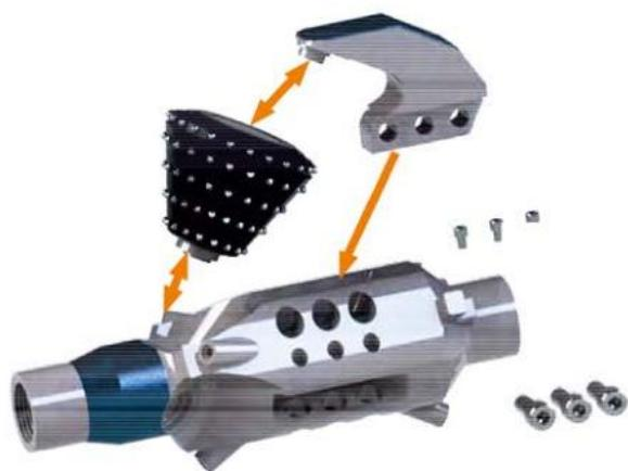
Вам не нужно покупать новый расширителем после окончания срока службы шарошечных элементов или их поломки, достаточно приобрести только комплект заменяемых элементов. Заменить легко вручную, на рабочем месте, открутив болты. Имея комплект сменных шарошечных элементов для разных грунтов и с разным вооружением, вы гарантированно и эффективно сможете работать одним расширителем в разных грунтах, от гальки до базальта.
