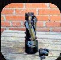
**БУРОВАЯ СКАЛЬНАЯ ГОЛОВКА «АЛМАЗНЫЙ КОГОТЬ»** обладает износостойкостью шарошечного долота (особенно в абразивных породах) с возможностью управления направлением бурения. Режущая часть головки, оснащенная АТП, является сменной.
