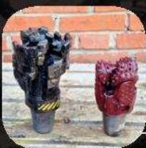
**БУРОВАЯ СКАЛЬНАЯ ГОЛОВКА «АЛМАЗНАЯ ЛАПА»** – альтернатива шарошечному долоту для бурения с помощью забойного двигателя. На головку не нужны большие нагрузки, благодаря чему скорость проходки «Алмазной лапой» д.у. 160 мм будет соизмерима со скоростью проходки шарошечным долотом д.у. 124 мм. В отличие от одноразового шарошечного долота, «Алмазная лапа» подлежит ремонту за счет сменных режущих частей, оснащенных АТП.
