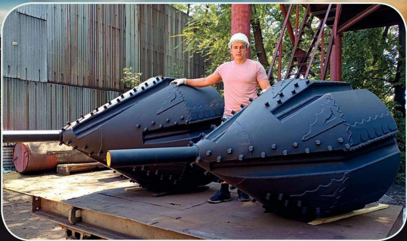
**РАСШИРИТЕЛИ «МОРКОВКА»** с удлиненной калибрующей частью. Расширители больших диаметров, не заполняемые бентонитом, что обеспечивает меньшую рабочую массу и нулевую плавучесть. Специальные накладки на корпусе не только повышают износостойкость, но и препятствуют эффекту присасывания калибрующей части к стенкам скважины.
